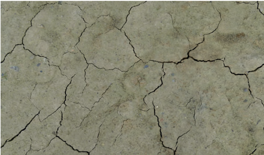
Typische Schwundrisse bei der nassen Methode (Bild: Walter Böhl).
