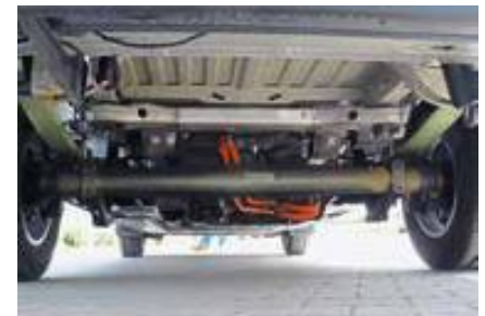
Die angetriebene und veredelte De-Dion-Hinterachse mit GfK-Blattfedern: Sie hält den Elektro-Transporter sicher in der Spur.
