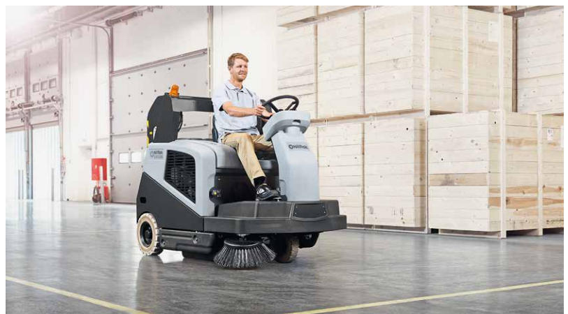
Trockene Bodenreinigung kann ausreichend sein. Dabei nehmen Kehrmaschinen mit eingebautem Staubbindingssystem aufliegende Stäube und groben Schmutz ebenso wie Verpackungs- und Palettenschnipsel sicher auf.
