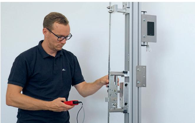
**7. Schritt:** Prüfen Sie nun die automatische Verriegelung über die Auslöseeinheit.
