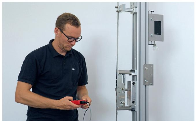
**8. Schritt:** Prüfen Sie das automatische Öffnen über die Control Unit. Das Upgrade ist damit abgeschlossen, die Antriebseinheit vorbereitet.
