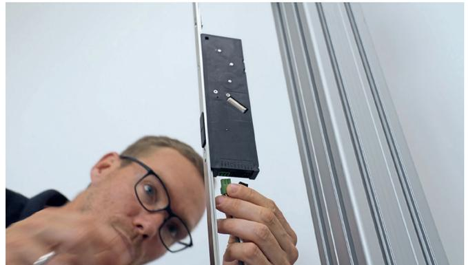
**4. Schritt:** Für die Inbetriebnahme schließen Sie die Antriebseinheit über die Plug & Play-Anschlüsse an den Strom an.
