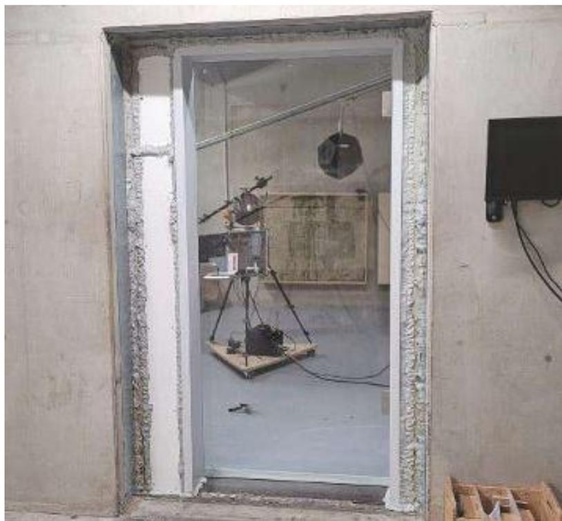
Eine Tür im Schallprüfstand mit Blick in den Empfangsraum.
