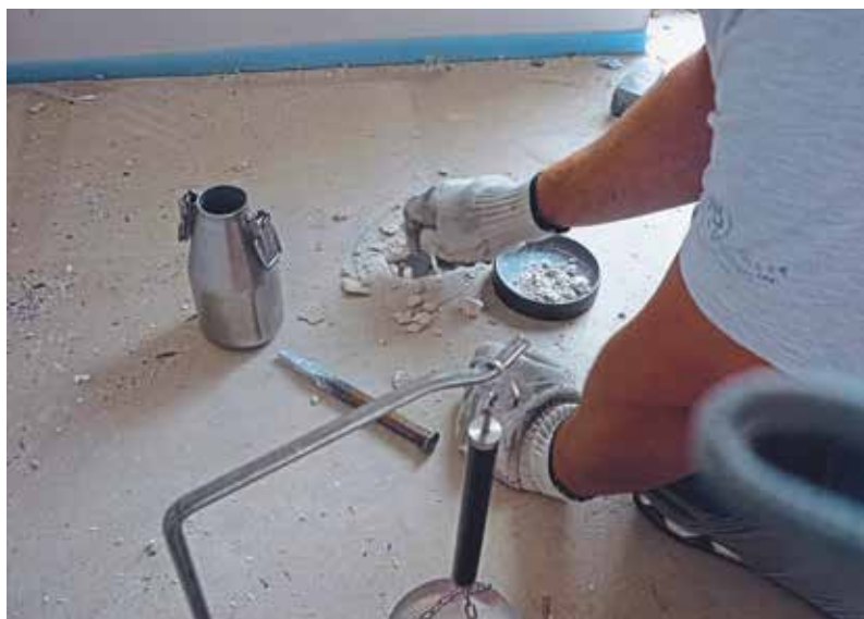
VDPM und IGE sehen daher nach wie vor die CM-Messung als die geeignete, baustellengerechte Prüfmethode an, um die Belegreife von Estrichen sicher zu bestimmen. Foto: Unger
