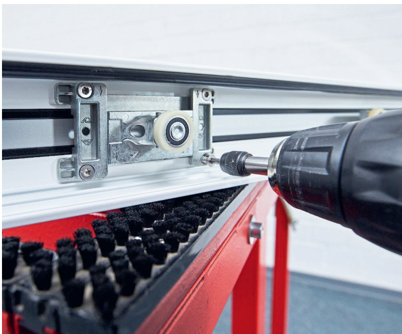
Optimiert für eine schnelle Montage: Mit jeweils nur vier Schrauben werden die Baugruppen des Schiebebeschlags Roto Patio Inowa montiert. Das Verschrauben von Mittelschließer, Laufwagen und Steuereinheiten in das Schiebeelement löst sofort die Mittenfixierung.
