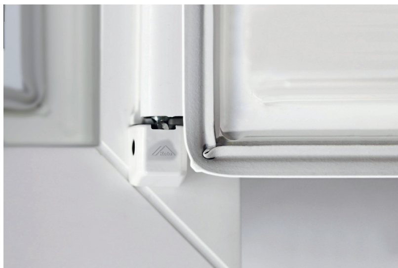
Das TPE-Dichtprofil Master Corner von Deventer kann einfach um die Ecke herumgeführt werden. Kein Einschneiden, kein Verschweißen. Ein schräg angestellter, harter Steg wirkt der Kraft, die das Aufstellen bewirkt, exakt entgegen. Ein Krepeln der Dichtung auf der Innenseite wird durch die Kombination aus hartem und weichem TPE minimiert.
