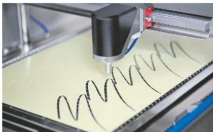
„Boty“ arbeitet mit einem Hochdruckwasserstrahl.
