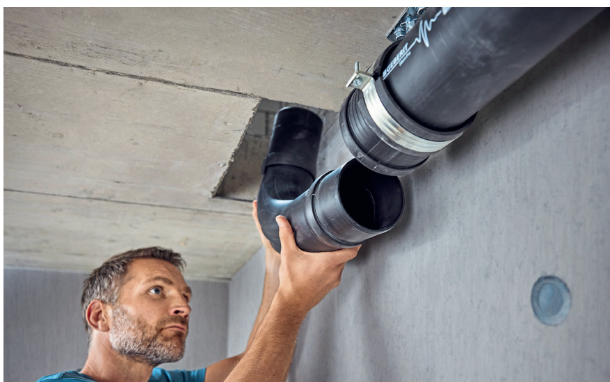
Die aufgesetzte Installation des Rohrschotts in U-Form ermöglicht einen minimalen Deckenabstand, ohne erhöhten Installationsaufwand. Der Silent-Pro BottomTurn Bogen ist mit zwei Steckenden ausgestattet und kann daher gegenläufig gesteckt werden.
