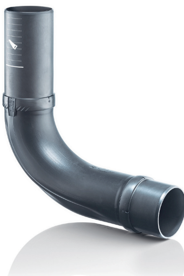
Der BottomTurn Bogen ist mit einem integrierten Strömungsteiler ausgestattet. Dieser leitet das Wasser gezielt als Schichtenströmung in die Horizontale. Dadurch bleibt die durchgehende Luftsäule erhalten.
