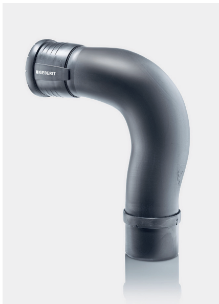
Der Silent-Pro BackFlip Bogen überführt die Schichtenströmung in eine Ringströmung, ohne dass ein hydraulischer Abschluss entsteht.
