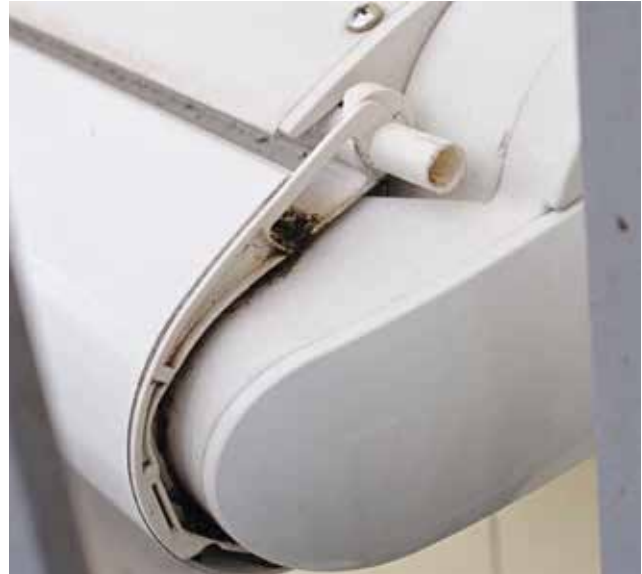
Die Abdeckkappe des Ausfallprofils hat sich bereits gelöst und ist zu Boden gefallen.
