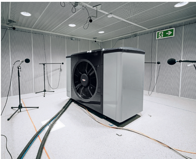
Das Wolf-Schalllabor ist entsprechend der Norm ISO 3744 für Schalleistungsmessungen der Genauigkeitsklasse 2 zertifiziert. Der Schalleistungspegel der Geräte wird entsprechend dieser Norm (ISO 3744) durch das Hüllflächenverfahren mit mindestens neun Mikrofonen bestimmt.
