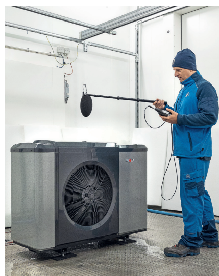
Vor Serieneinführung werden bei Wolf die Schallwerte durch externe Prüflabore, wie beispielsweise von TÜV Süd, verifiziert.
