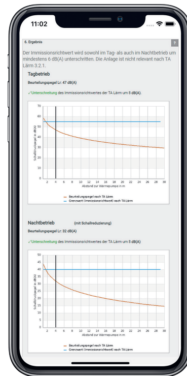
Mithilfe des Schallrechners können auf Basis der vom Hersteller fachgerecht ermittelten Schalleistungspegel Aufstellbedingungen bewertet werden, und zwar sowohl für den Tag- als auch für den Nachtbetrieb.
