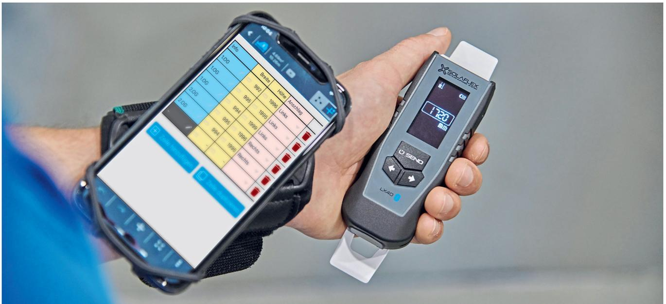
**Datenerfassung 2.0:** Die Messwerte werden via Bluetooth automatisch vom digitalen Rollmeter oder Laser-Entfernungsmesser in die Solaflex Aufmaß-App übertragen.
